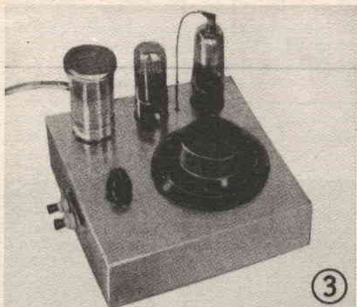
Veduta della parte esterna dello chassis, notare la disposizione dei comandi che ha permesso di fare a meno del pannello frontale.
